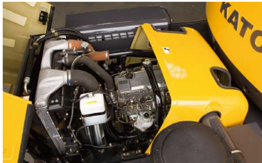
▲メンテナンス性を考慮したレイアウトのエンジンルーム
