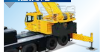
① センターウエイト 7.4t 旋回後端半径 3.3m
