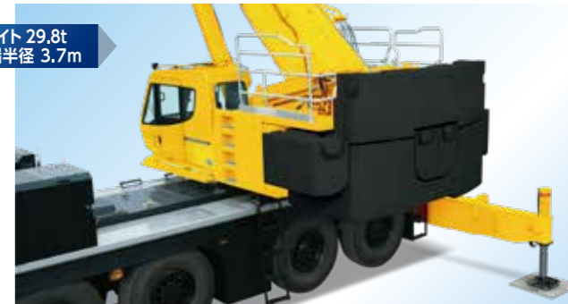
③ センターウエイト 21.8t 旋回後端半径 3.7m
