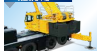
② センターウエイト 15.3t 旋回後端半径 3.7m
