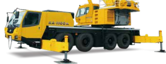
① センターウエイト 7.4t 旋回後端半径 3.3m
