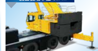
③ センターウエイト 21.8t 旋回後端半径 3.7m
