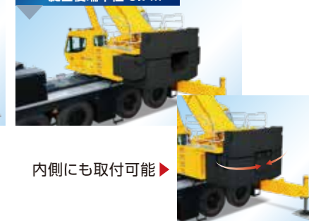
④ センターウエイト 25.8t 旋回後端半径 3.7m
